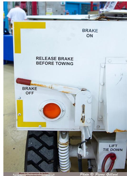
*Commande de frein mécanique : frein appliqué à gauche et relâché à droite.*
