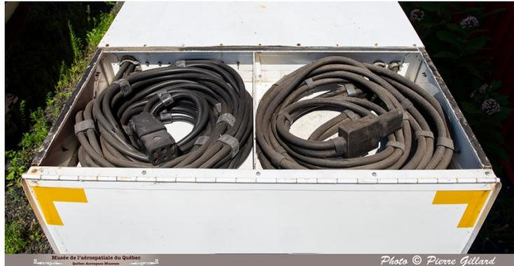
Câbles de sortie AC (à gauche) et DC (à droite).
