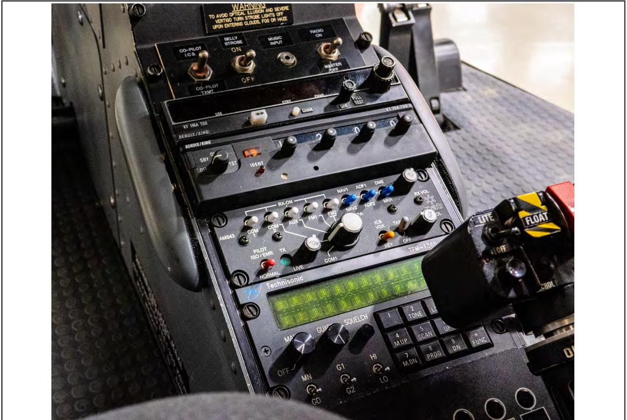
Figure 4-2 : Console audio et ICS de l'EC120B C-GLSP.
