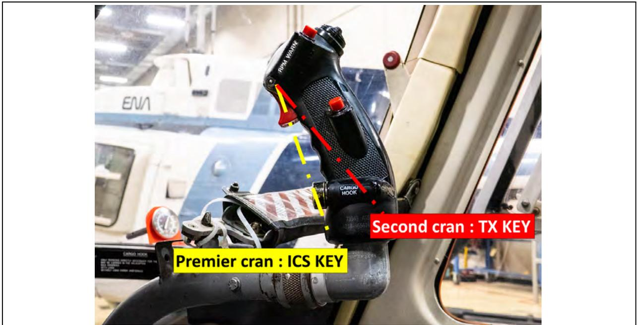
Figure 3-3 : Commande de pas cyclique.
