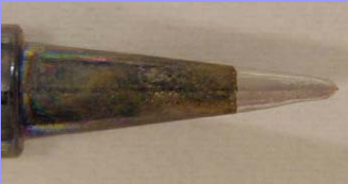
La panne après 20000 soudures étain plomb
