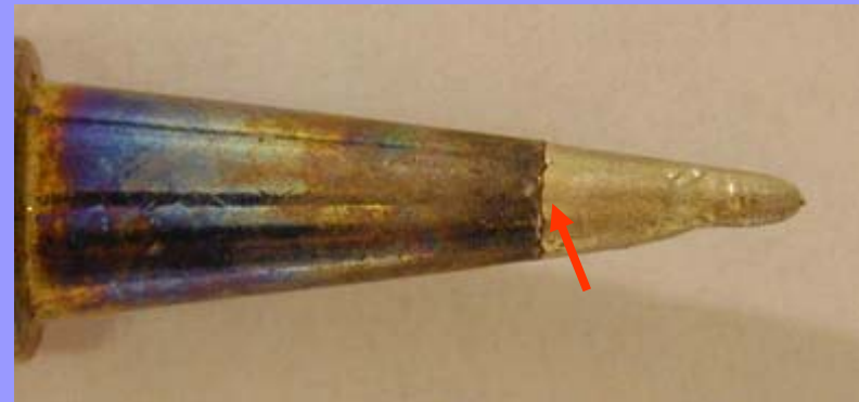
La panne après 10000 soudures sans plomb
