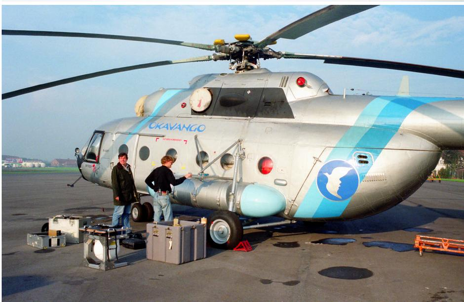
**En haut et ci-dessus : équipe de Wim Robberechts & Co. à l'aéroport d'Ostende venue pour installer et effectuer les essais d'un système Wescam 16 sur le Mil Mi-8 de l'Opération Okavango. Au centre : l'interphone Telex ProCom 2 modifié pour être installé sur le Mi-8 (Pierre Gillard).**
