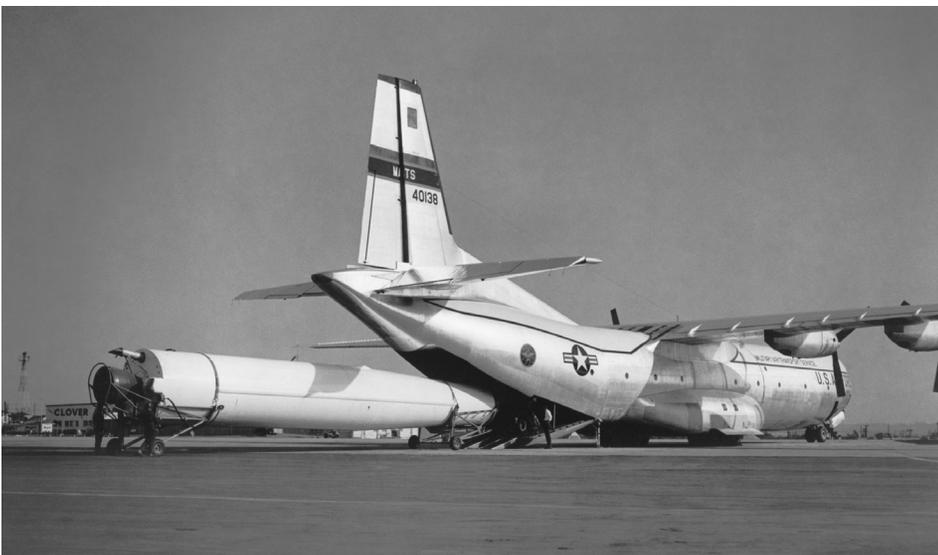
Pour les ingénieurs de la *Douglas Aircraft Company* le défi est de taille. Après trois itérations dans le processus de développement, ils optent pour un avion quadriturbopropulseur à aile haute disposant d'une vaste soute de 27 mètres de long et de 3,7 mètres de haut qui est aussi pressurisée, chauffée et ventilée. Le volume dis-
